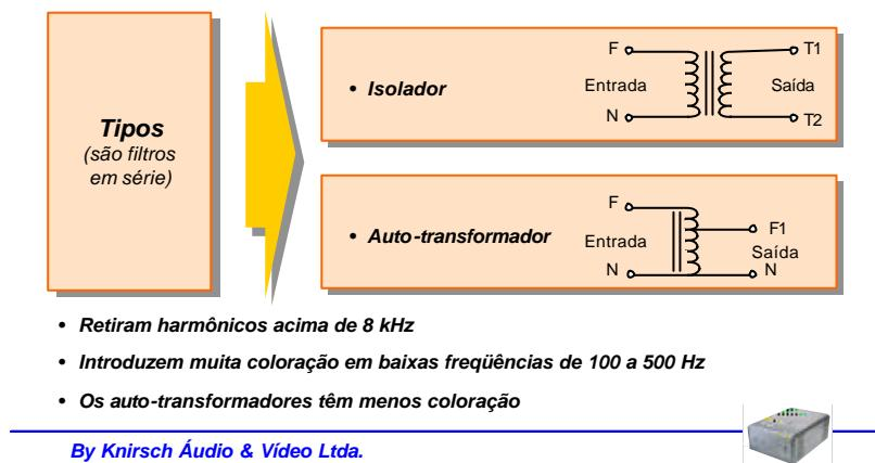
Os transformadores são componentes elétricos, colocados em série com a rede elétrica que, além de transformar os níveis de tensão, também têm propriedades de filtragem. Conseguem retirar harmônicos da rede somente a partir de 8KHz. Quando os conectamos aos sistemas de áudio e vídeo, surgem mudanças sonoras que, de início, podem parecer até muito agradáveis, pois a primeira impressão que nos dão é que o som
